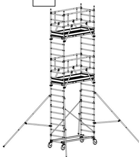
Pour la version Totem constituée de plateau bac, les opérations sont les mêmes à part qu'il n'y a pas de plinthes à monter, les plinthes sont intégrées au plateau.
