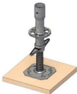
Commencer en déposant le matériel au sol dans la zone de montage. Positionner l'embase dans le socle réglable, et utiliser des socles en bois sous les socles afin de répartir la charge dans le sol.
